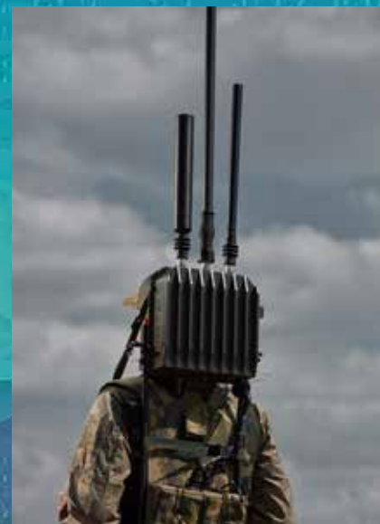
KIRPI – система нейтралізації саморобних вибухових пристроїв
